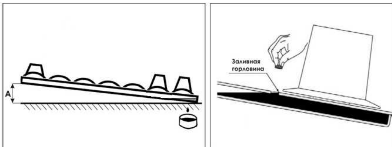
Рисунок 8.3 – Проверка уровня масла в режущем аппарате
