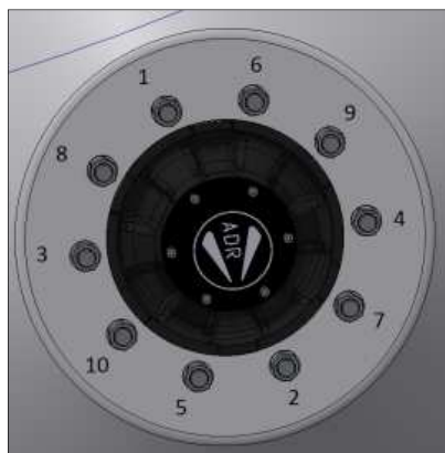
Рисунок 5.1 - Порядок затяжки колесных гаек
