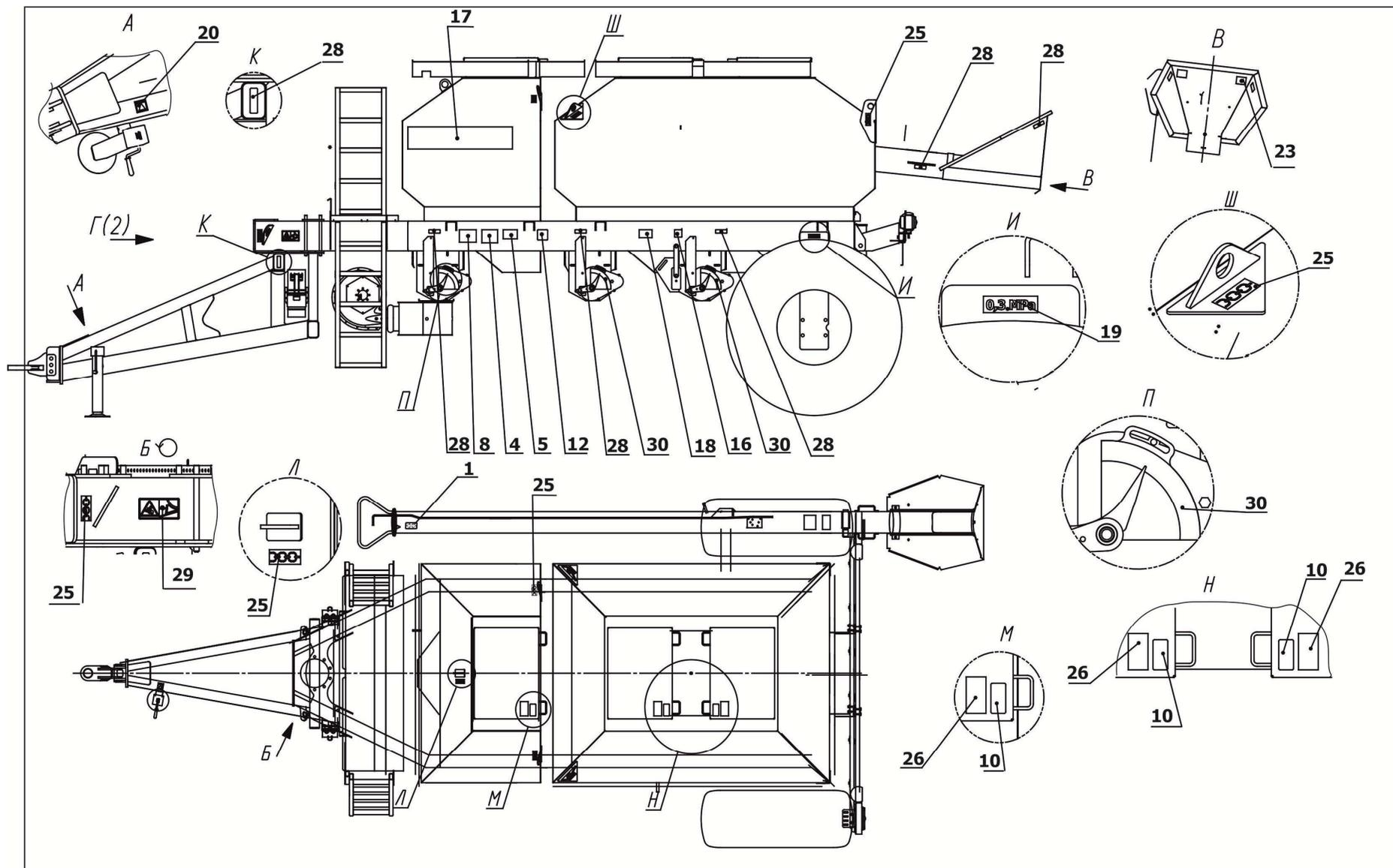
Рисунок 4.1 – Схема расположения табличек и аппликаций на бункере
