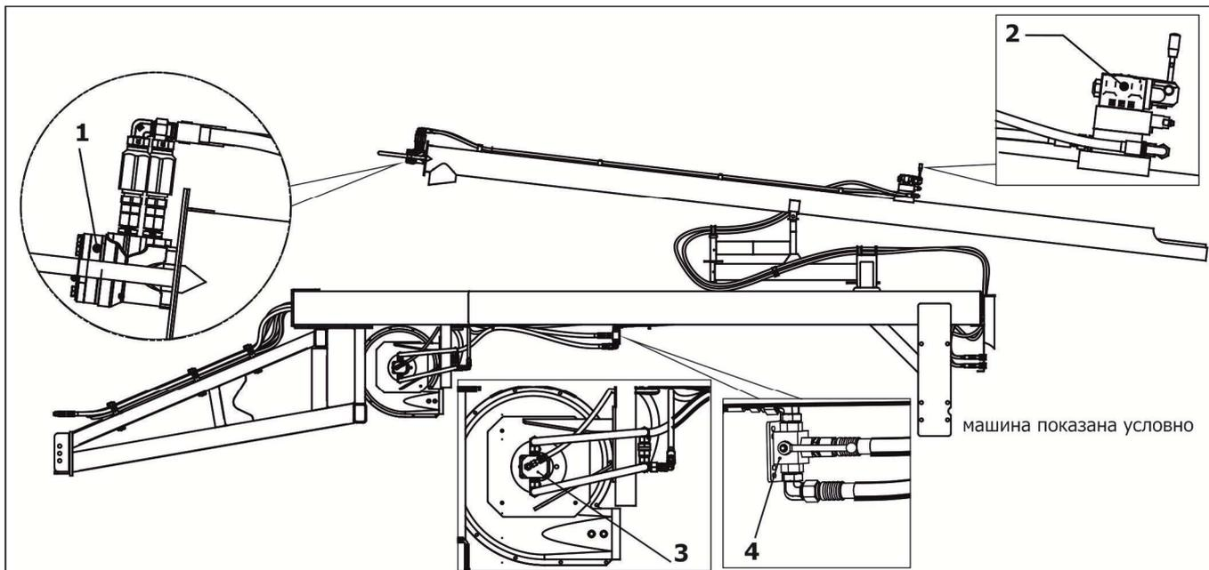
1 - гидромотор героторный; 2 - гидрораспределитель с ручным управлением; 3 - гидромотор;
