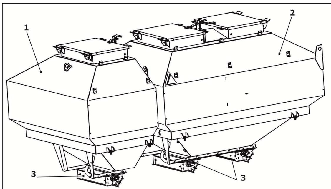
1 - передний бункер; 2 - задний бункер; 3 - аппарат высевающий
