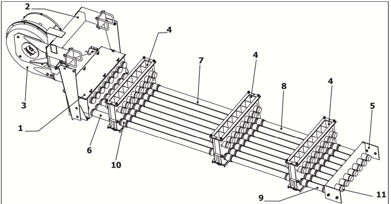
1 – корпус; 2 – рамка; 3 – вентилятор; 4 - распределитель; 6, 7, 8, 9 – труба; 10 – трубка; 11 - заглушка
