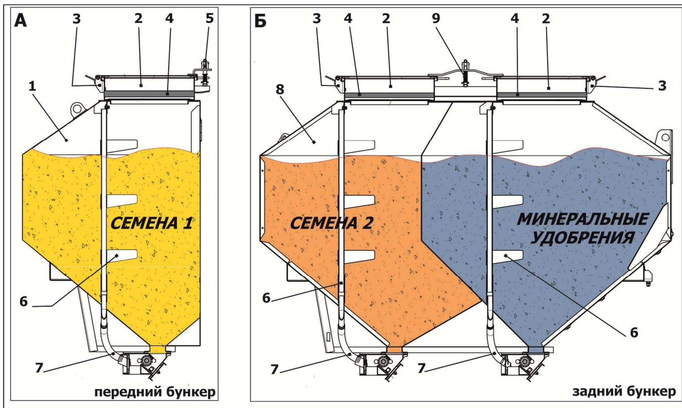
1, 8 – резервуар; 2 – крышка; 3-петля; 4 – решетка; 5, 9 – фиксатор; 6 – стойка; 7 – шланг
