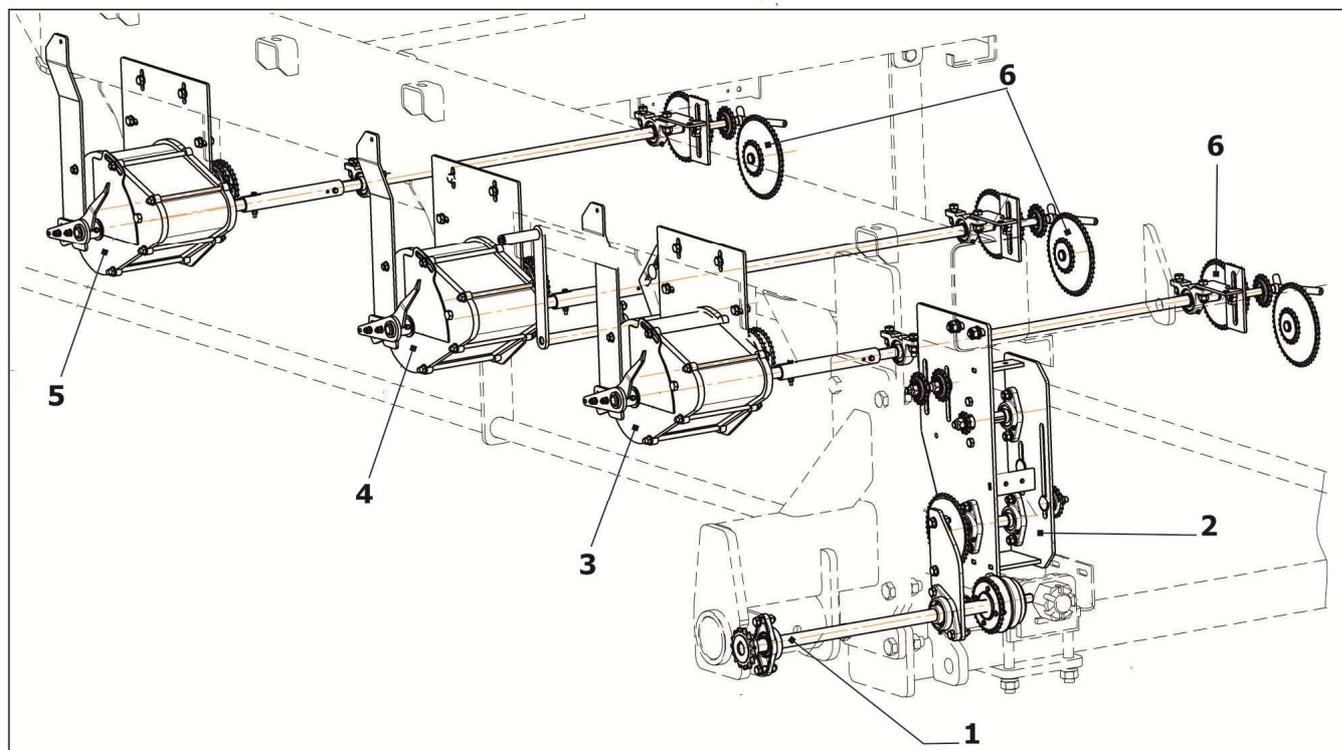
1 - главный привод; 2 - редуктор привода; 3, 4 5 – редуктор; 6 - высевающий аппарат
