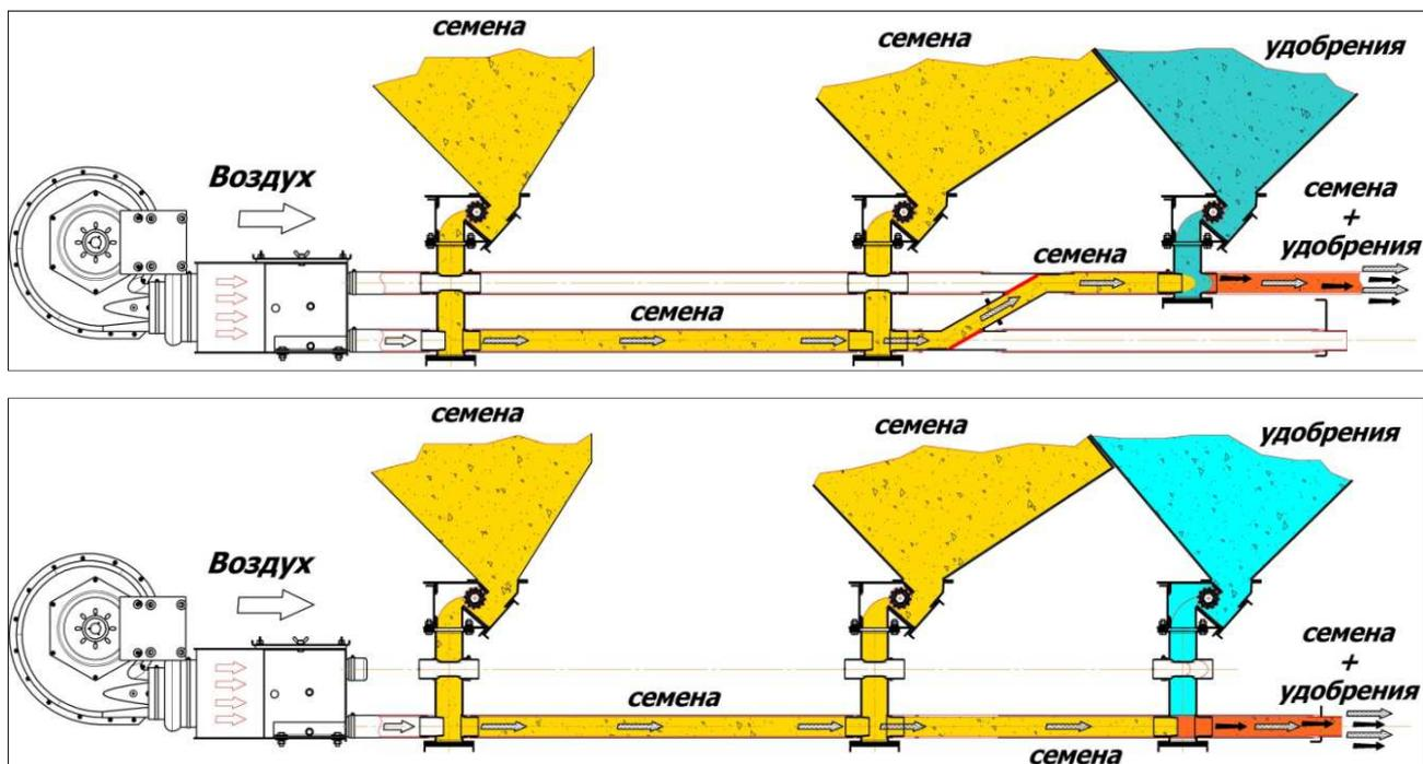
Рисунок 2.13 – Технологическая схема работы однопоточной системы дозирования
