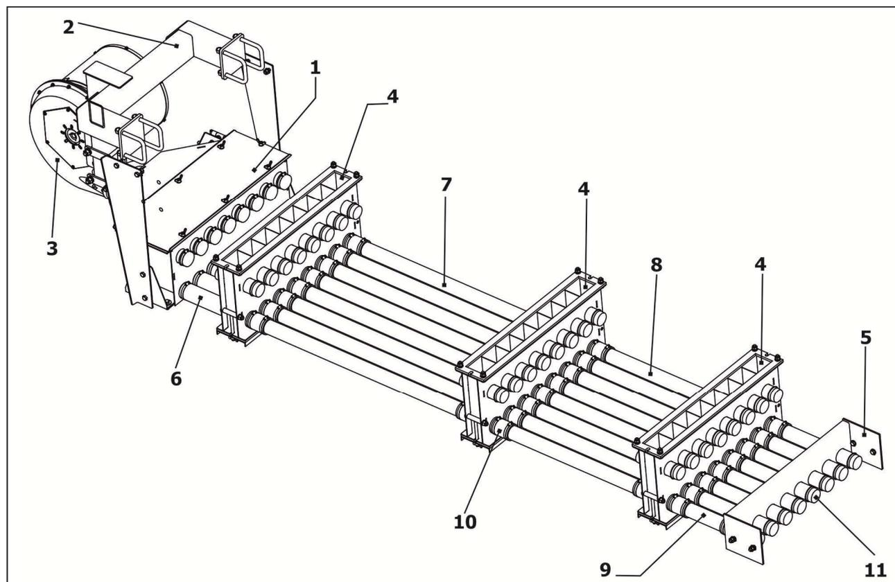
1 – корпус; 2 – рамка; 3 – вентилятор; 4 – распределитель; 6, 7, 8, 9 – труба; 10 – трубка;
