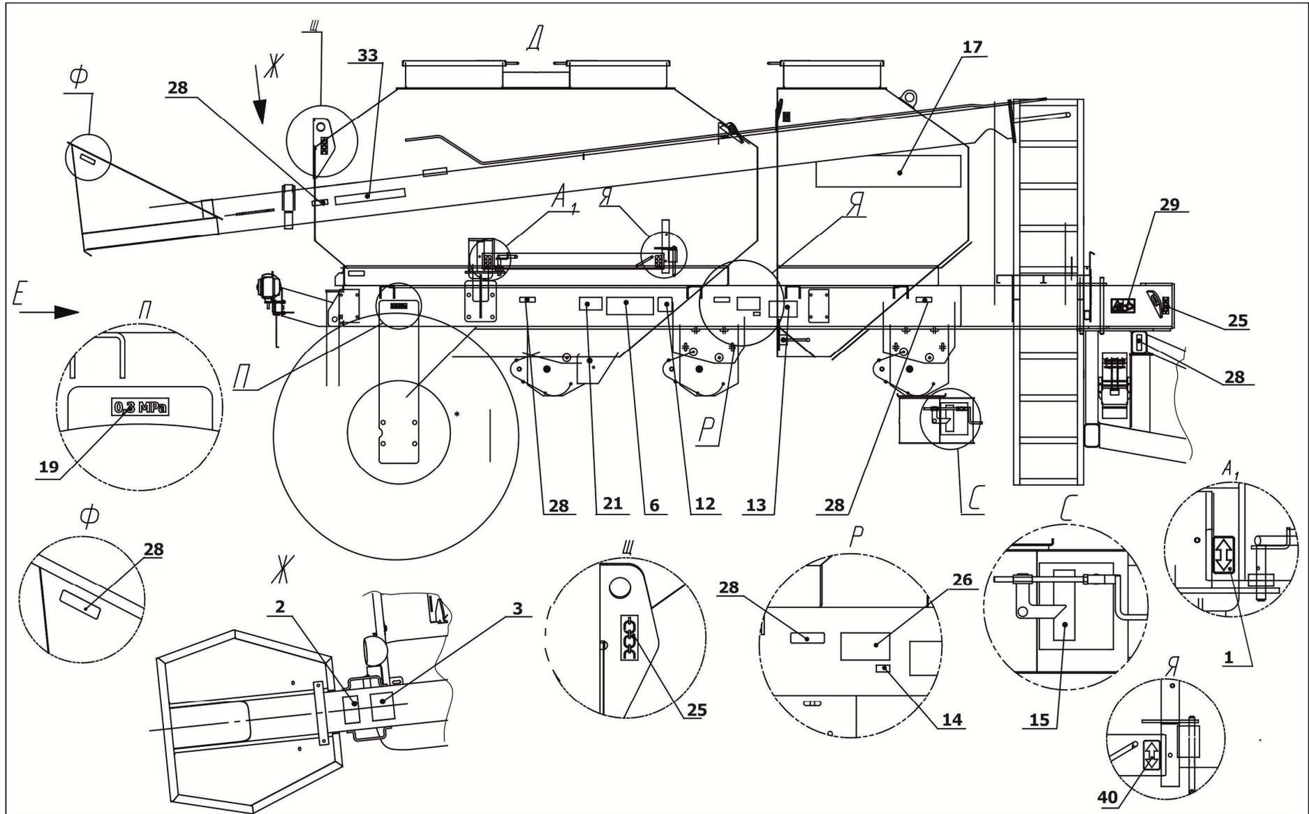
Рисунок 4.3 – Схема расположения табличек и аппликаций на бункере
