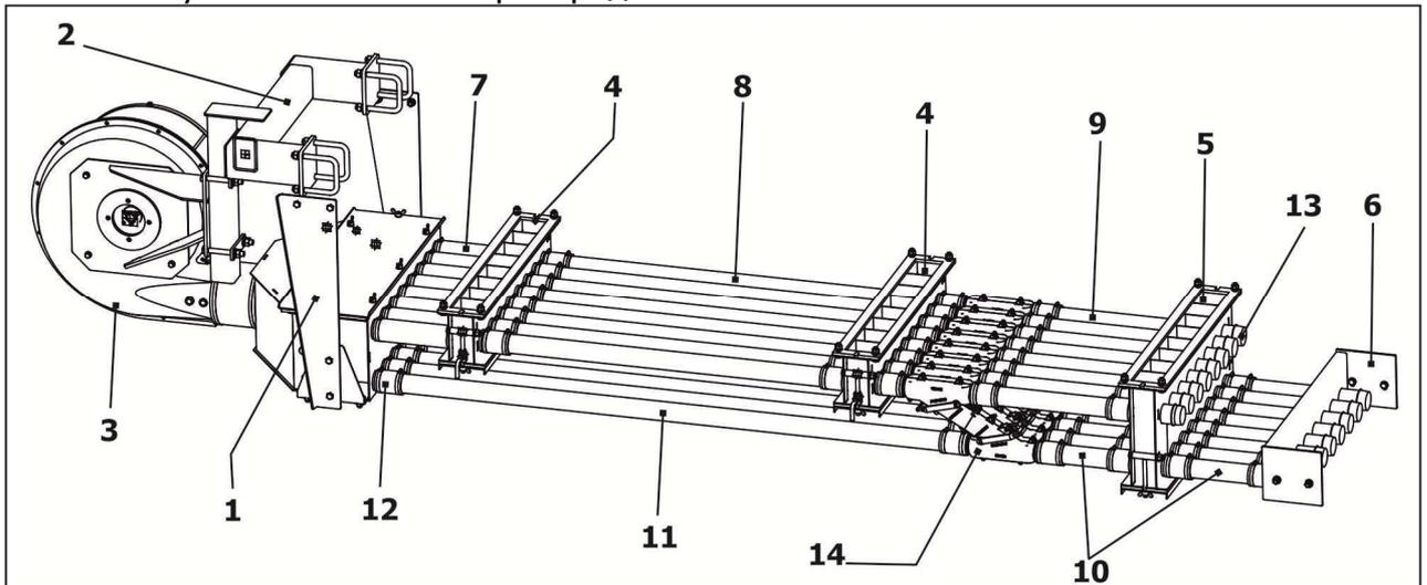
1– корпус; 2 – рамка; 3 – вентилятор; 4, 5, 6 - распределитель; 7, 8, 9, 10, 11 – труба; 12 – трубка; 13 - заглушка; 14 - клапан
