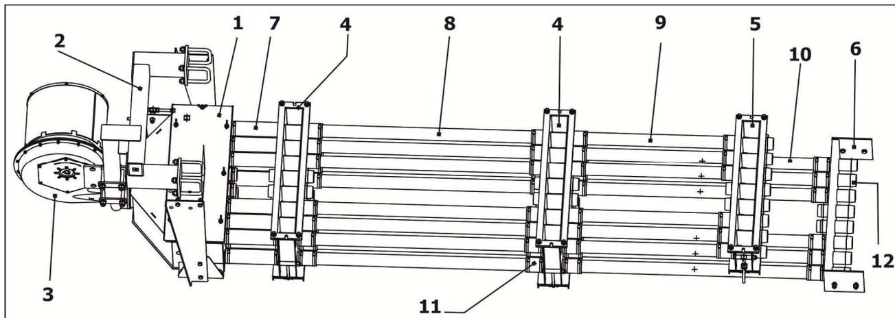
1– корпус; 2 – рамка; 3 – вентилятор; 4, 5, 6 - распределитель; 7, 8, 9, 10 – труба; 11- трубка;
