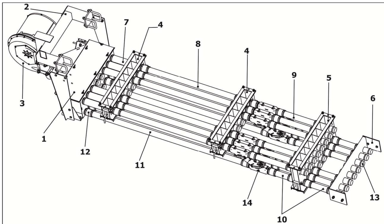
1 – корпус; 2 – рамка; 3 – вентилятор; 4, 5, 6 – распределитель; 7, 8, 9, 10, 11 – труба;
