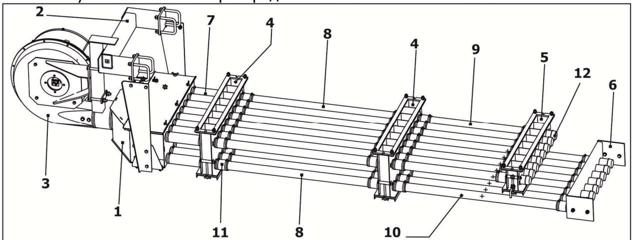
1– корпус; 2 – рамка; 3 – вентилятор; 4, 5, 6 - распределитель; 7, 8, 9, 10 – труба; 11- трубка; 12 - заглушка
