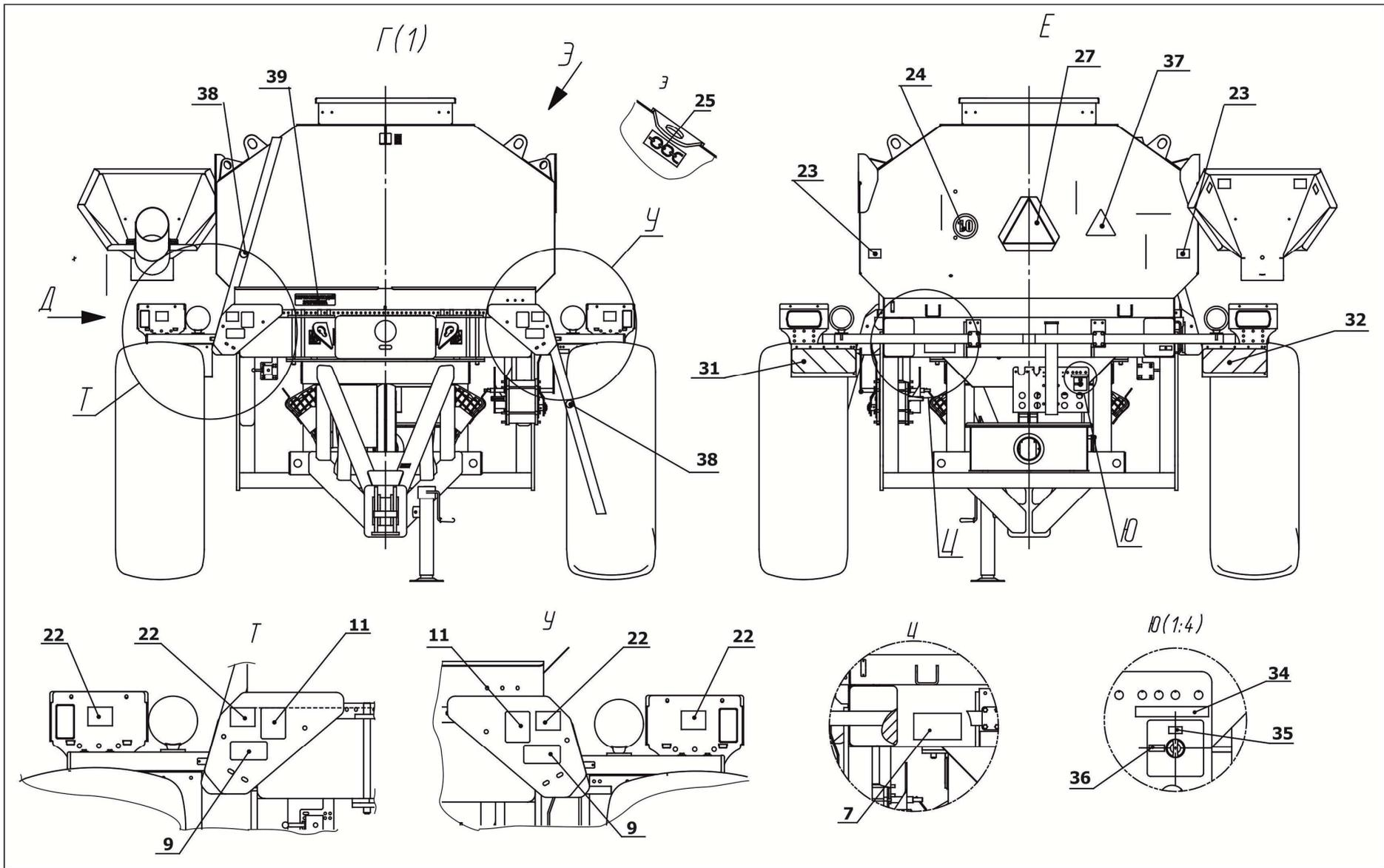
Рисунок 4.2 – Схема расположения табличек и аппликаций на бункере
