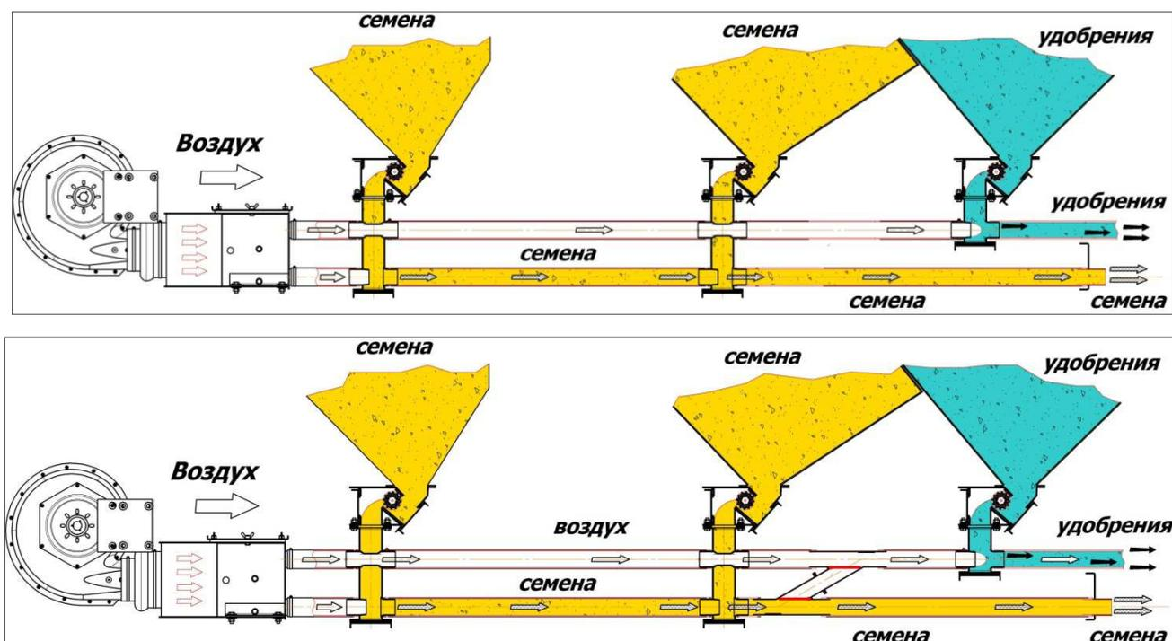
Рисунок 2.14 – Технологическая схема работы двухпоточной системы дозирования
