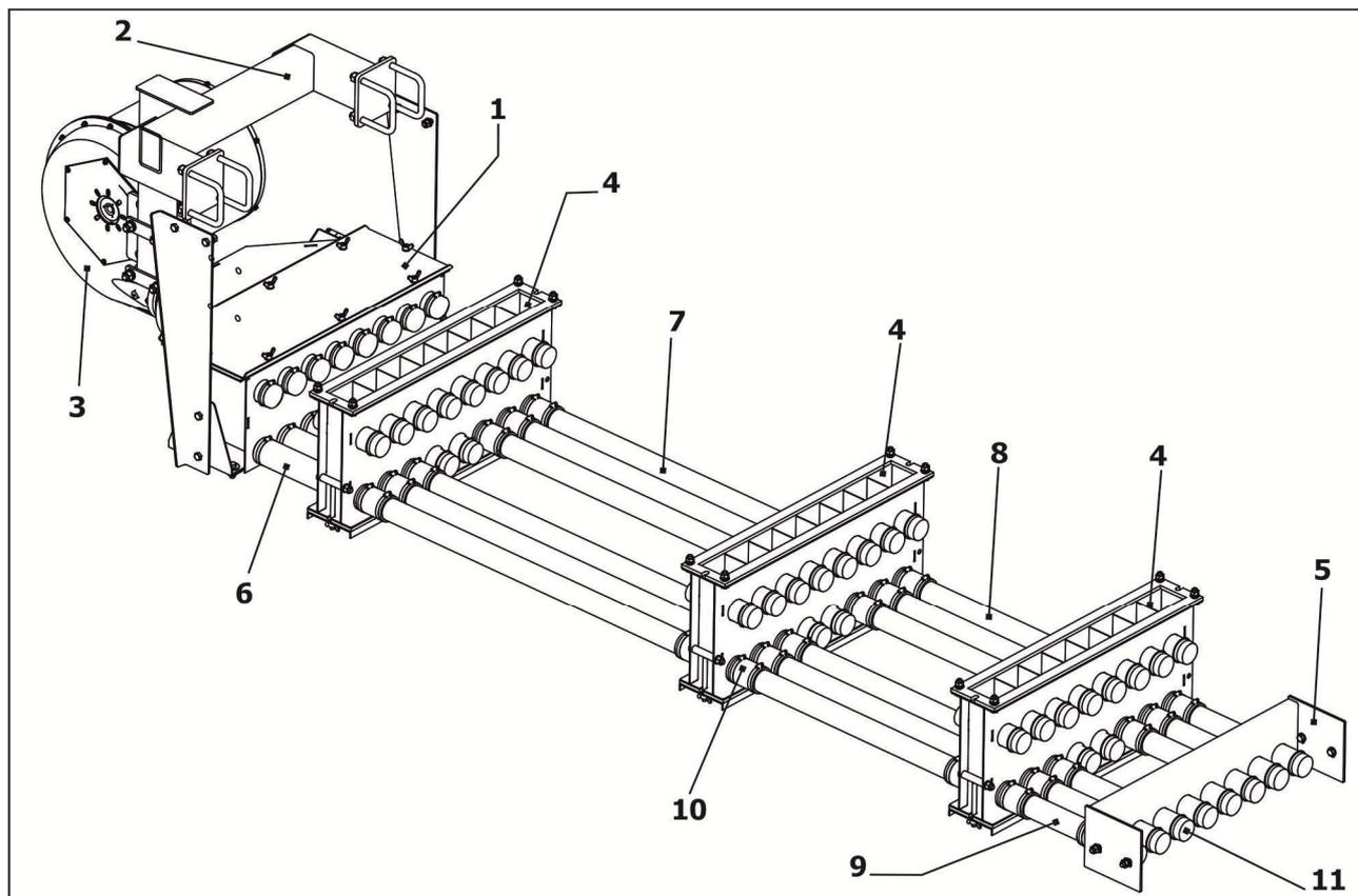
1 – корпус; 2 – рамка; 3 – вентилятор; 4 – распределитель; 6, 7, 8, 9 – труба; 10 – трубка; 11 – заглушка
