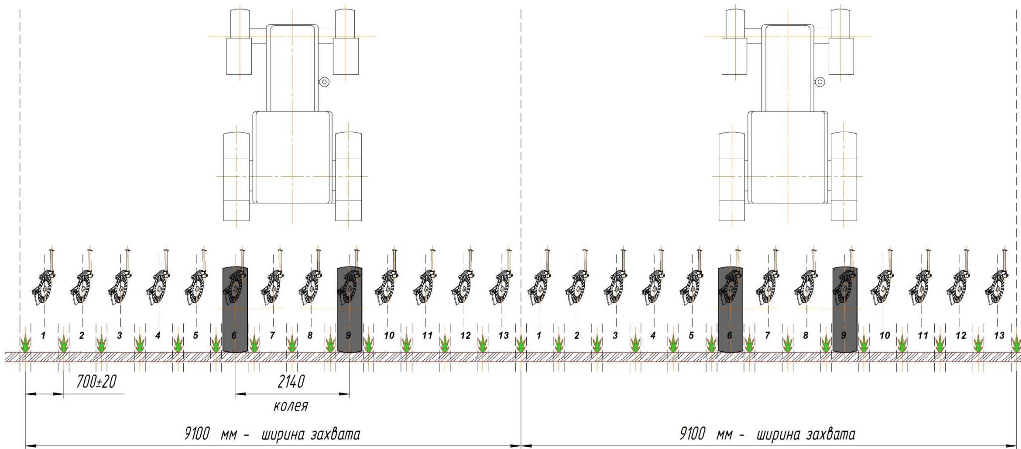
Рисунок А.2 – Схема обработки аппликатора АР-3000/13, АР-4000/13, ширина захвата 9,1 метра
