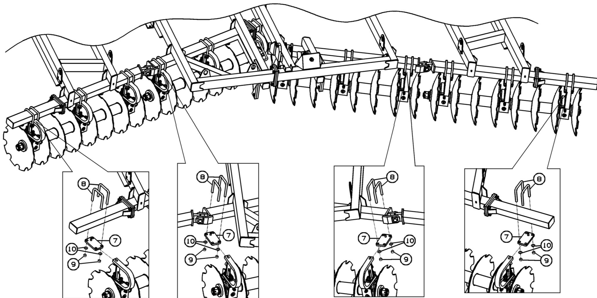
Рисунок 14 – Установка дисковых батарей ДХ-880.03.000 (вид спереди)
