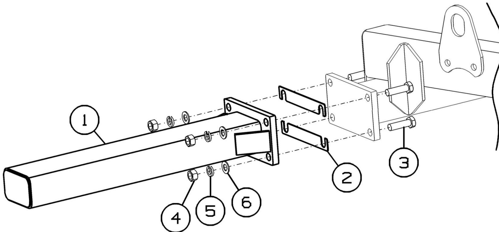
Рисунок 12 – Удлинитель рамы ДХ-880.06.020
