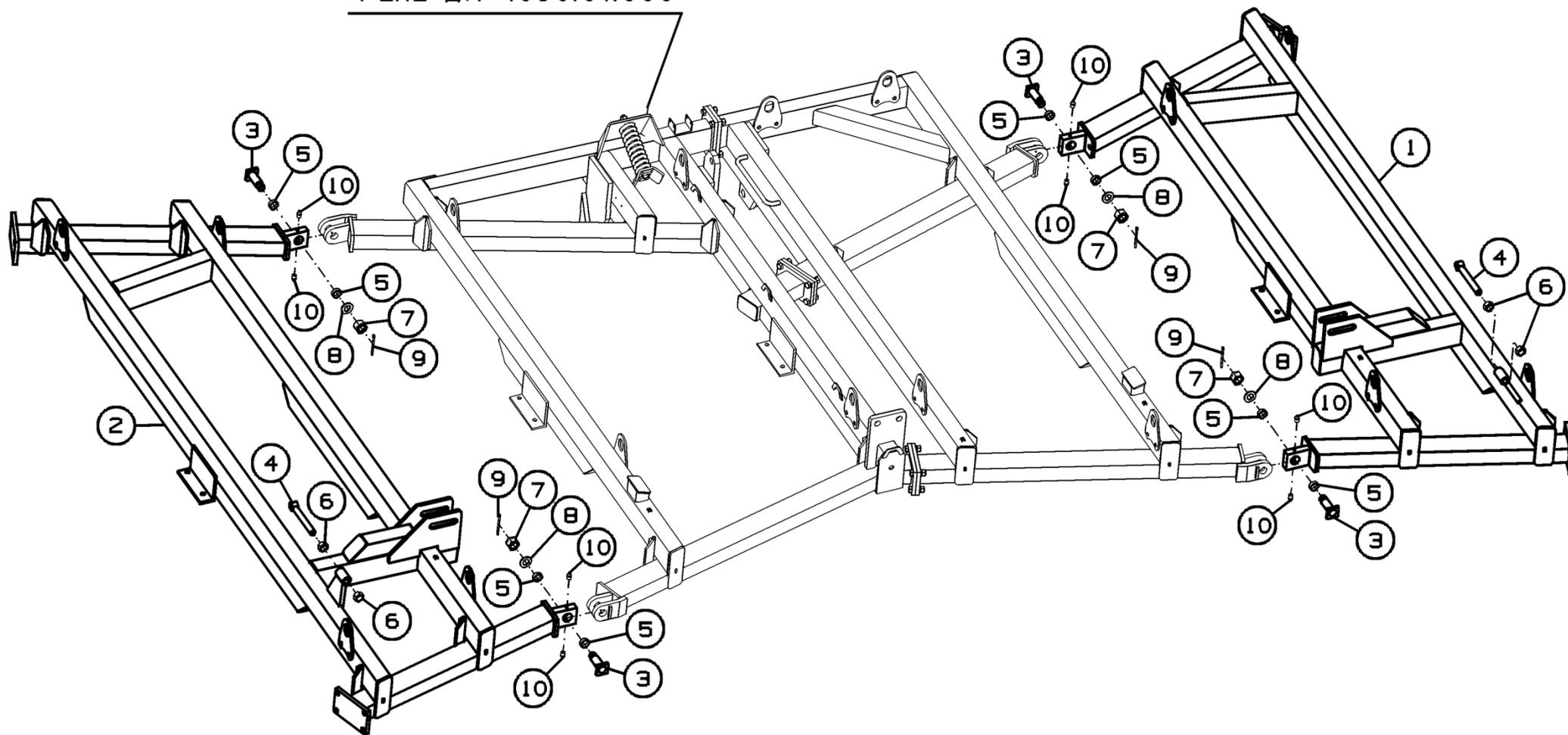
Рисунок 8 – Установка секций ДХ-880.02.000
