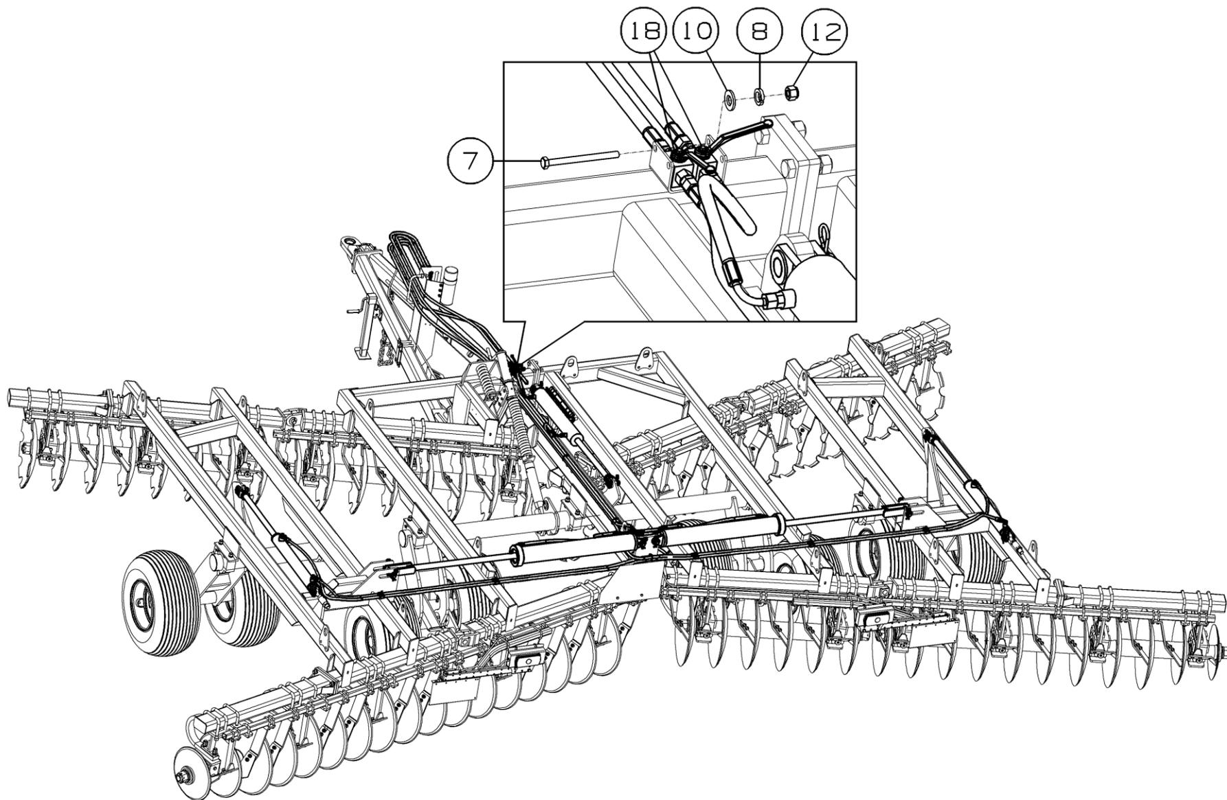
Рисунок 30 - Установка гидрооборудования ДХ-1080.12.000-01
