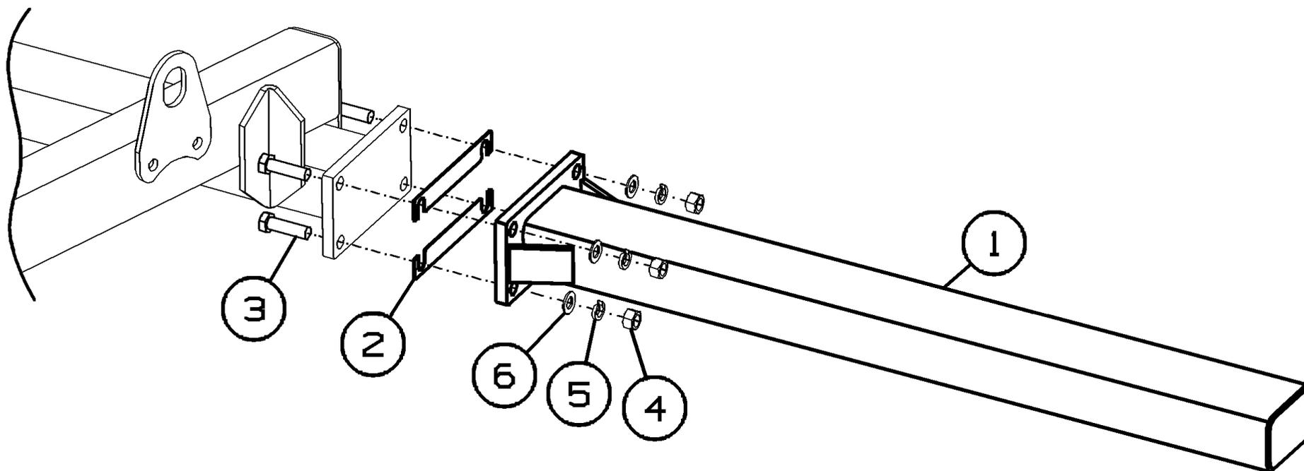
Рисунок 11 – Удлинитель рамы ДХ-880.06.010
