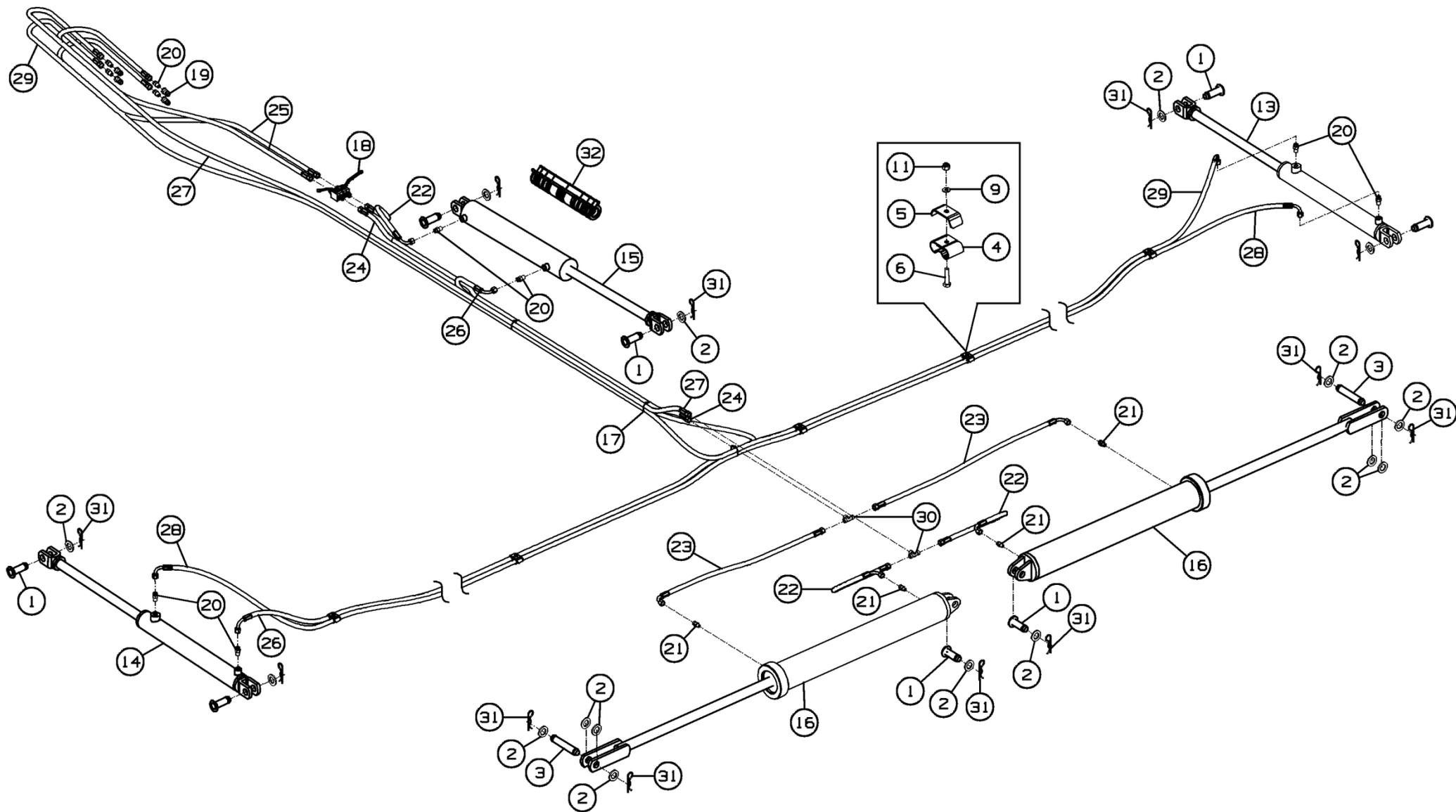
Рисунок 31 - Установка гидрооборудования ДХ-1080.12.000-01
