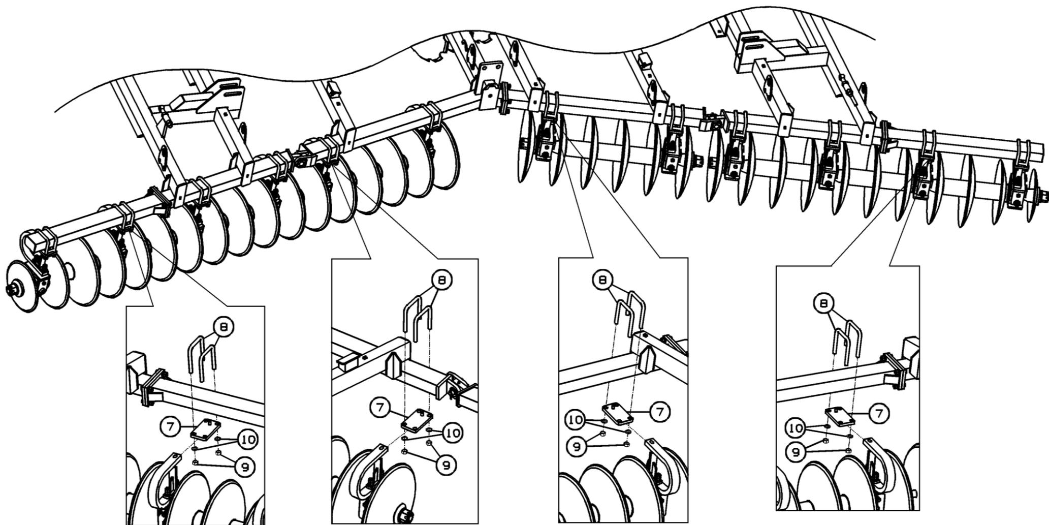
Рисунок 15 – Установка дисковых батарей ДХ-880.03.000 (вид сзади)
