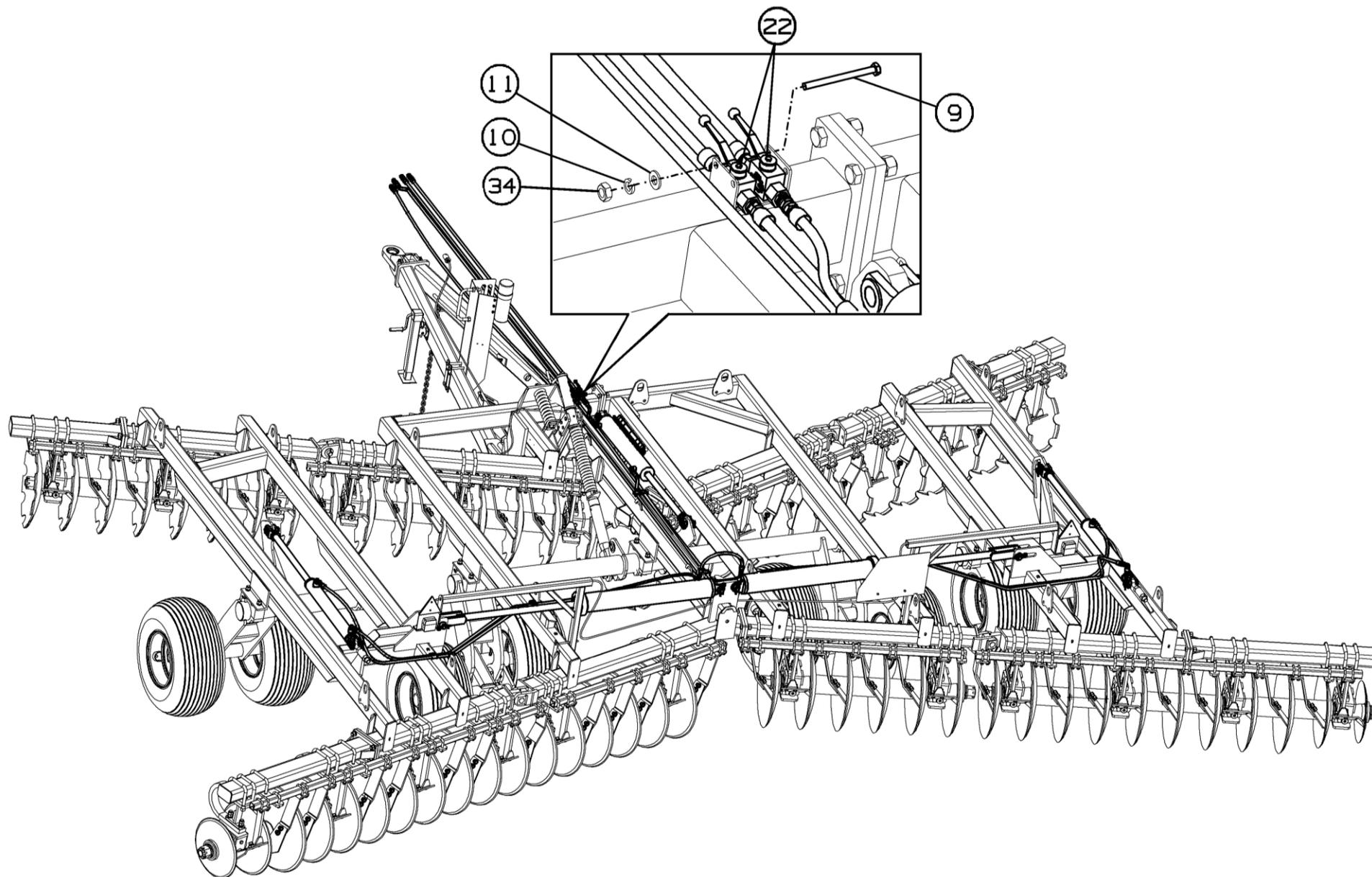
Рисунок 28 – Установка гидрооборудования ДХ-880.12.000
