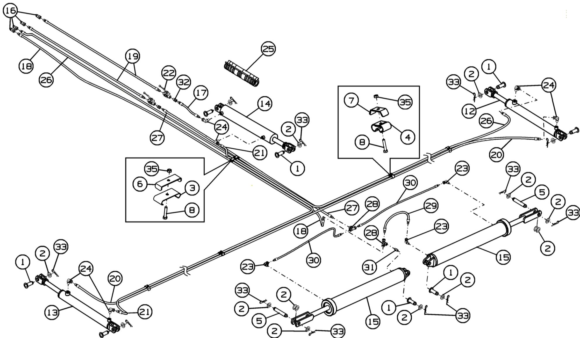
Рисунок 29 – Установка гидрооборудования ДХ-880.12.000
