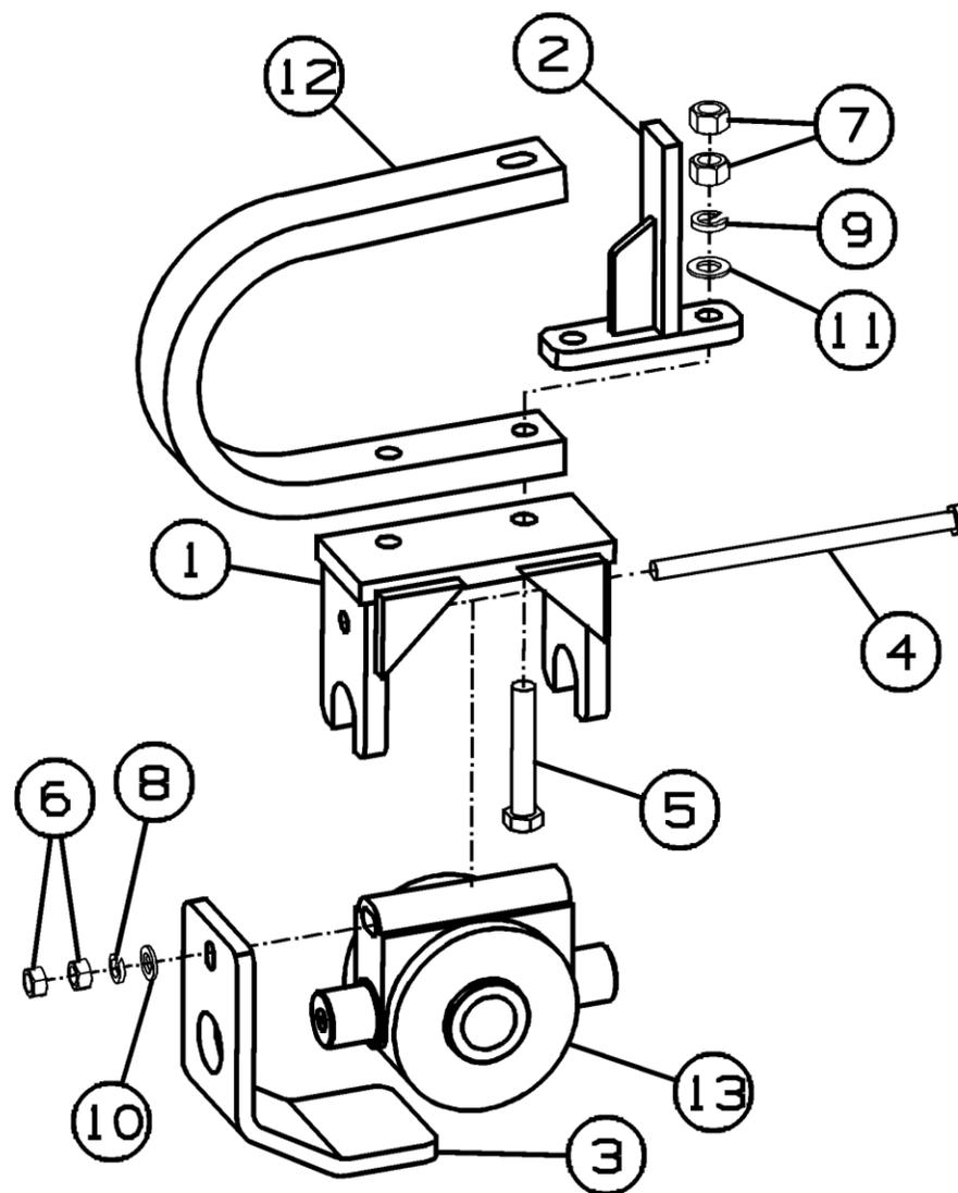
Рисунок 22 - Стойка в сборе ДХ-1080.03.500, ДХ-1080.03.600
