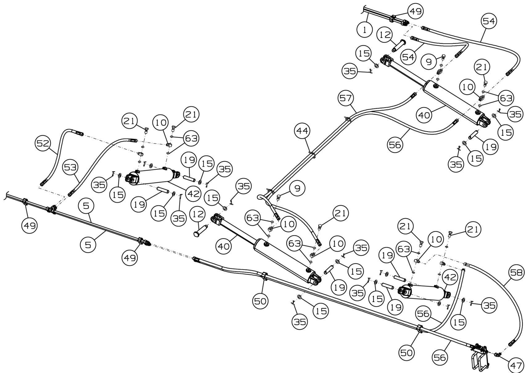
Рисунок 22 - Установка гидрооборудования К-183.12.000Б
