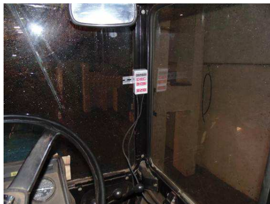
Рисунок 5.26 – Установка пульта управления в кабине трактора
