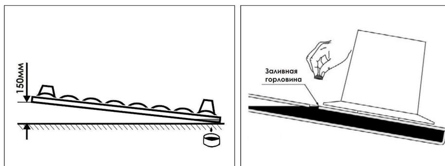
Рисунок 7.3 - Проверка уровня масла в режущем аппарате
