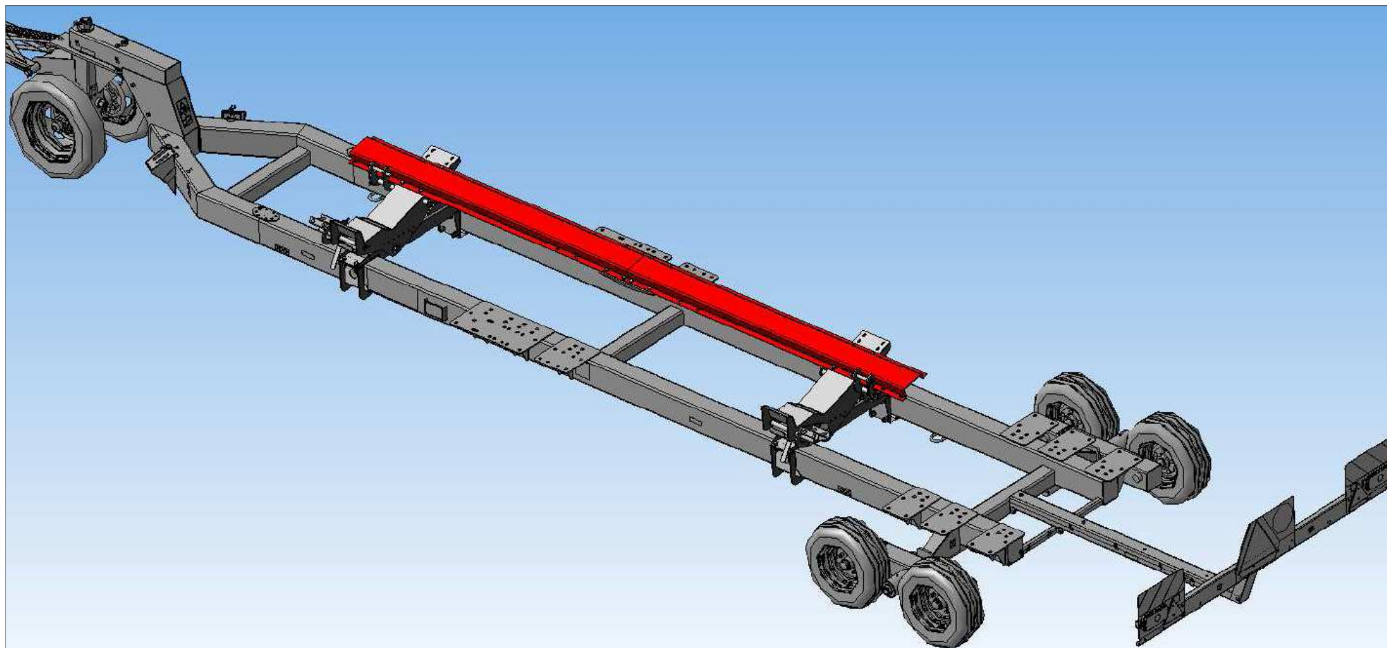
Рисунок Д.2 – Приспособление для перемещения адаптеров ППА-4000 "Uni Cart 4000" для RSM SS-490 с комплектом для транспортировки SS-490.13.00.000А
