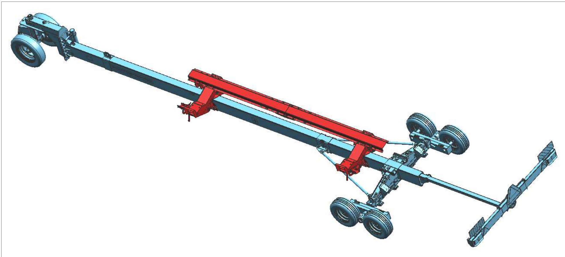
Рисунок Д.6 - Приспособление модульное для перемещения адаптеров ПМА-4000 «Pro Cart 4000» для жатки RSM SS-490 (SS-560) с комплектом для транспортировки SS-490.23.00.000 (SS-490.23.00.000-01)
