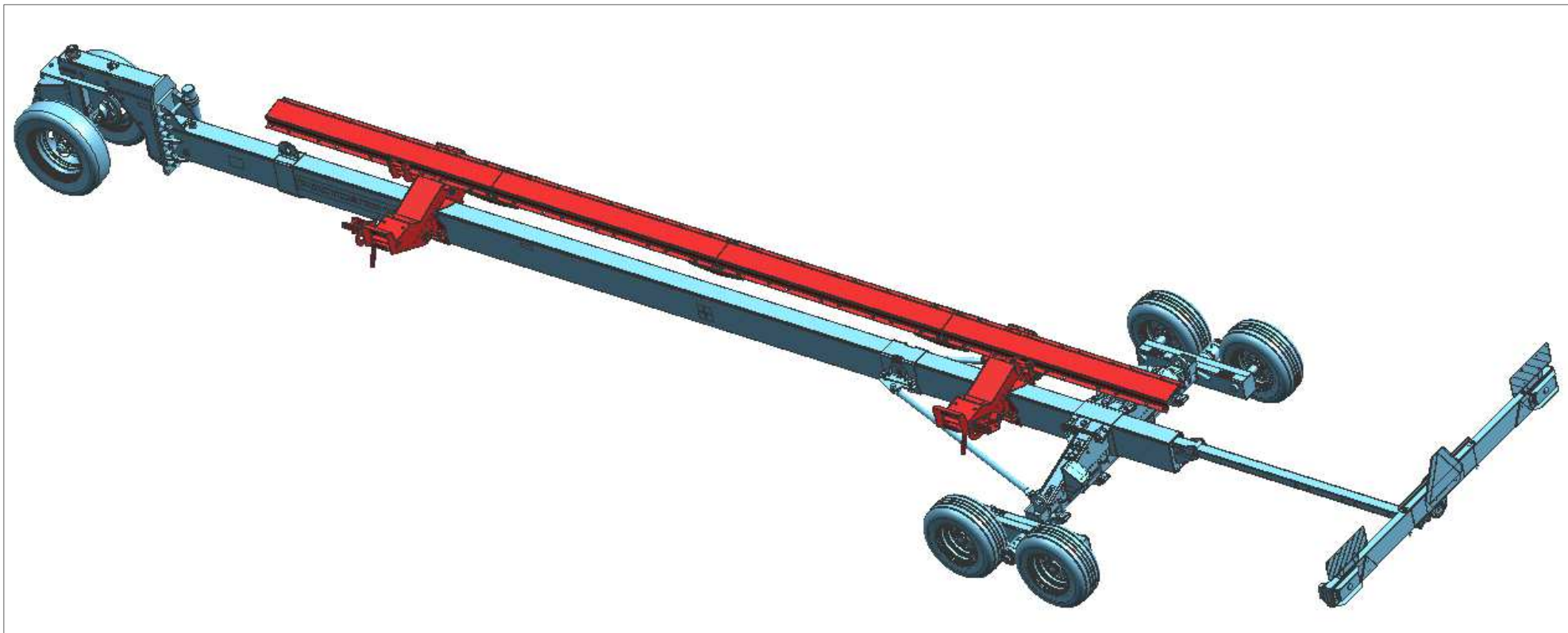
Рисунок Д.10 - Приспособление модульное для перемещения адаптеров ПМА-4000 «Pro Cart 4000» для жатки RSM SS-650 с комплектом для транспортировки SS-780.23.00.000
