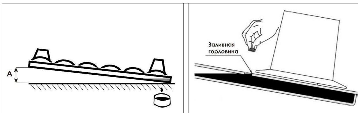
Рисунок 7.3 - Проверка уровня масла в режущем аппарате
