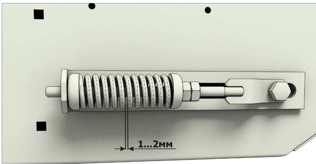
Рисунок 2.10 - Контроль натяжения транспортеров стеблей
