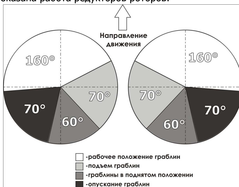
Рисунок 3.3 - Схема работы кольцевых направляющих дорожек редукторов роторов
