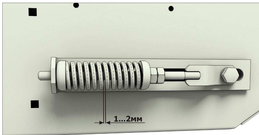
Рисунок 2.10 - Контроль натяжения транспортеров стеблей
