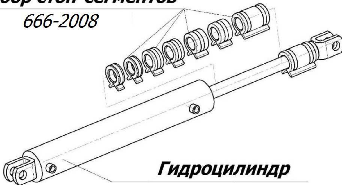
Рисунок 6.2 – Установка стоп-сегментов на шток гидроцилиндра
