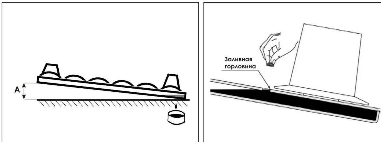
Рисунок 8.3 – Проверка уровня масла в режущем аппарате
